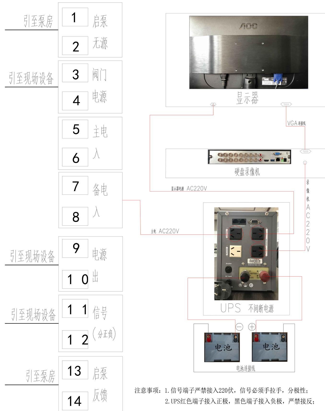
注意事项：1. 信号端子严禁接入220伏，信号必须手拉手，分极性；
